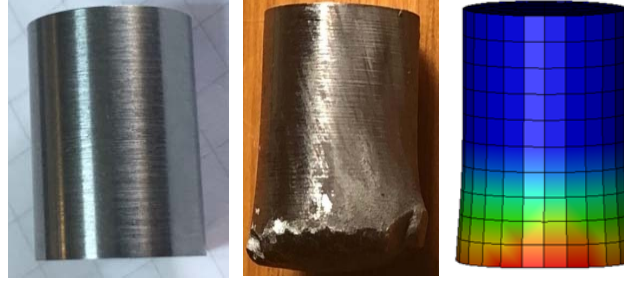
Şekil 19 - YDB. (a) Orijinal delici , (b) Delici hasar görüntüsü,(c) Sayısal analiz hasar görüntüsü.
