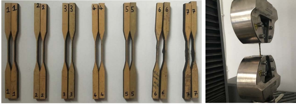
Şekil 3.1. - Bambu çekme numuneleri ve çekme testi
