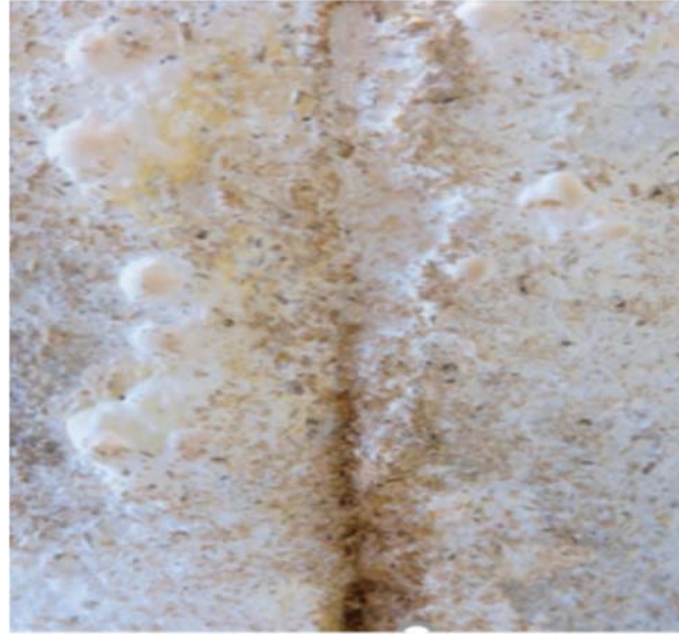
Şekil 10 - Miselyum tuğlalarının yaklaşık bir hafta sonra birbirine bağlanması.
