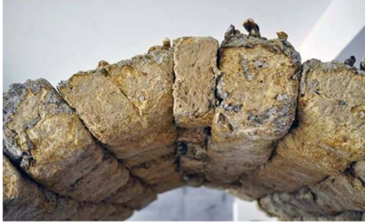
Şekil 7 - Miselyum tuğlası esasında canlı organizmaları besleyen ve barındıran bir yapı malzemesidir [17].
