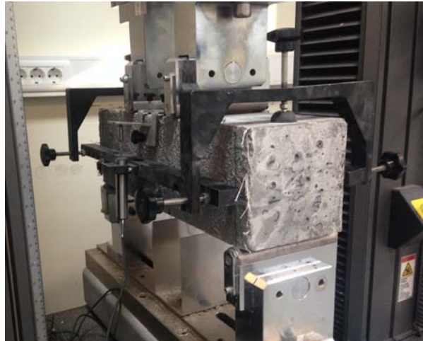
ASTM C 1609 test düzeneği
