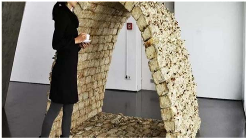
Şekil 6 - ABD'li tasarımcı Phillip Ross tarafından Miselyum tuğlaların sağlamlığını göstermek için 1,80 x 1,80 metre ölçülerinde yapılan bir kemer [17]
