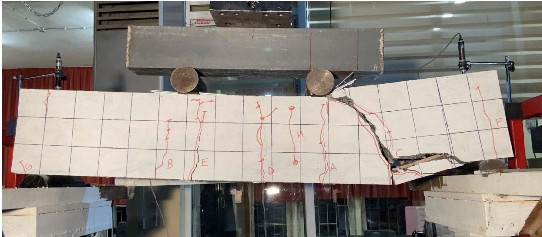
Şekil 3.12. - BBRC kirişi dört nokta eğilme deneyi, göçme anı
