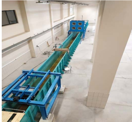
Şekil 3 - Dalga üreticisinin yerleştirildiği dalga kanalı
