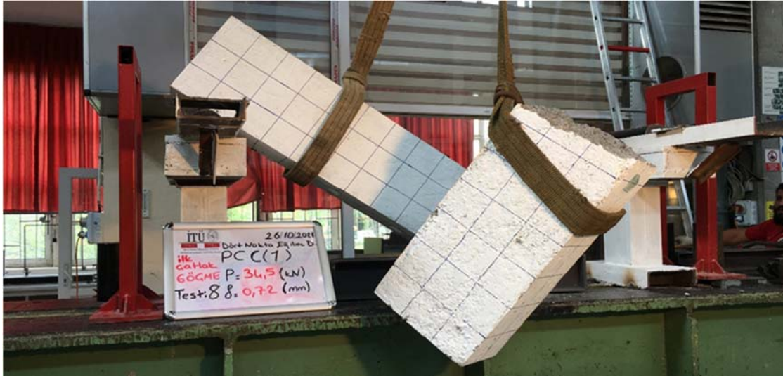
Şekil 3.6. - PCC kiriş deneyi; P=34.5 kN, \delta=0.72 mm
